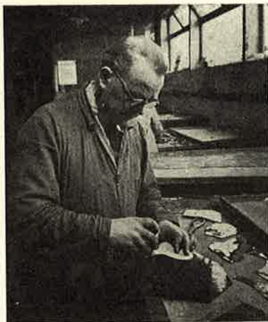
Snel flitst de glassnijder met het diamant langs schabloon op het glas
